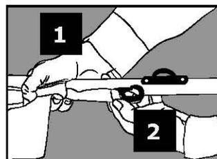
► Fixer le mousqueton de la voile sur le pontet existant du tube **(A)**
