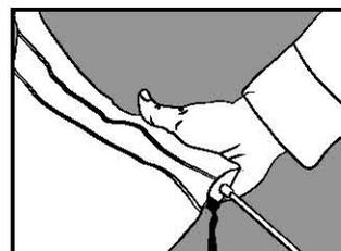
► Enfiler la voile sur le jonc **(C)** jusqu'au tube **(A)**
